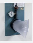
Contrôle étanchéité Recherche de fuite (Pression 70 à 100 mm CE, 700 à 1000 Pascal).
