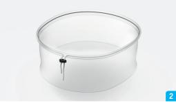
Ces accessoires souples sont fabriqués dans des feuilles plastiques techniques de qualité, calandrées et cristal. Différents types de feuilles plastiques peuvent être utilisés: PVC cristal (ep.0,3 à 0,48mm), PVC blanc (ep.0,5 à 0,75mm) et PVC translucide azuré (ep.0,3 à 0,5mm).
