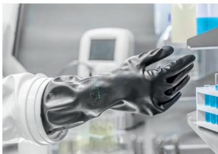
PIERCAN propose une solution innovante brevetée, mise au point par son laboratoire de recherche et développement : la première bague de connexion sécurisée (BCS) permettant le changement de gant sans perte de confinement.
